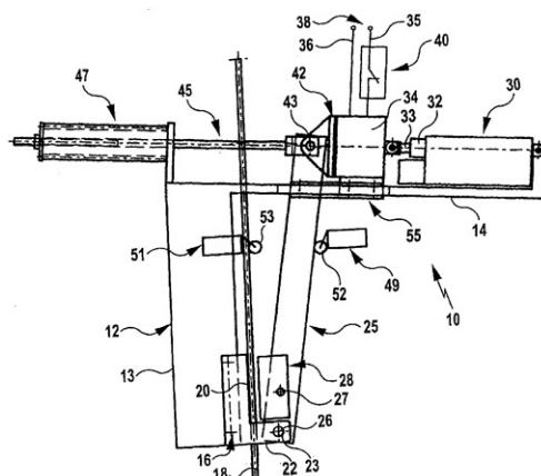
1. 一种升降机装置的绳制动机 (10; 60), 其用于制动联接到轿厢的绳 (18), 并且具有在绳的纵向上不可移动的阻挡器 (16) 和至少一个制动器闸瓦 (28), 该绳 (18) 可以在阻挡器 (16) 和制动器闸瓦 (28) 之间导向通过, 并且制动器闸瓦 (28) 可以在将该绳 (18) 压在阻挡器 (16) 上的制动位置和释放该绳 (18) 的释放位置之间来回移动, 并且该绳制动机还具有联接到制动器闸瓦 (28) 用于释放该绳 (18) 的驱动器 (30), 其特征在于驱动器被形成为线性驱动器 (30) 并且所述至少一个制动器闸瓦 (28) 能借助于线性驱动器 (30) 逆着在制动位置作用在其上的制动力的作用而转移到释放位置。
